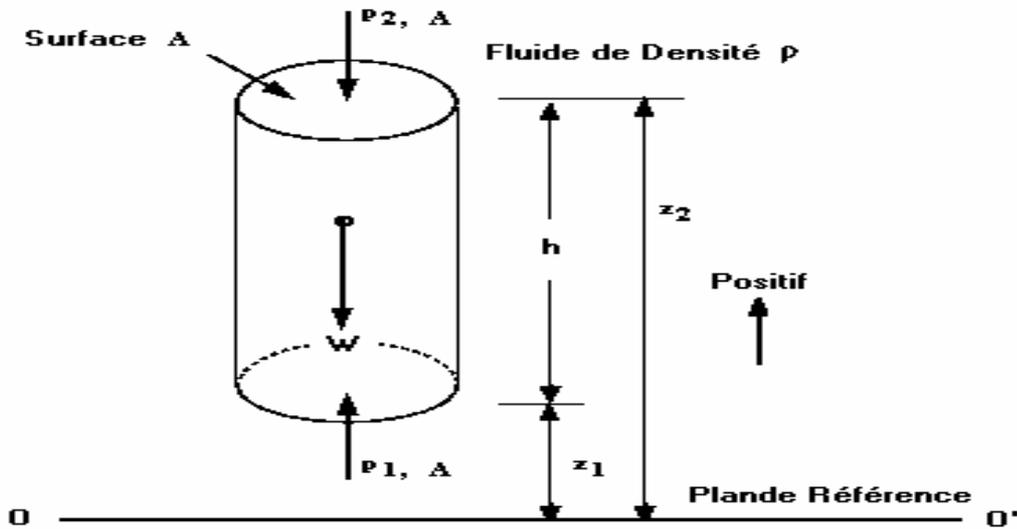
Soit un élément de fluide de masse spécifique  $\rho$  représentant une colonne verticale de section transversale constante  $A$ . Considérons 2 sections situées à des distances  $Z_1$  et  $Z_2$  par rapport à un plan de référence  $OO'$ . Soient  $P_1$  et  $P_2$  les pressions dans ces 2 sections.
