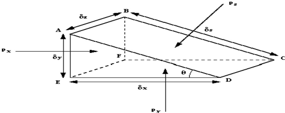
Considérons un élément d'un fluide ABCDEF ( prisme triangulaire ) et soient  $P_x$  ,  $P_y$  et  $P_s$  les pressions dans les 3 directions  $x$  ,  $y$  et  $s$  .
