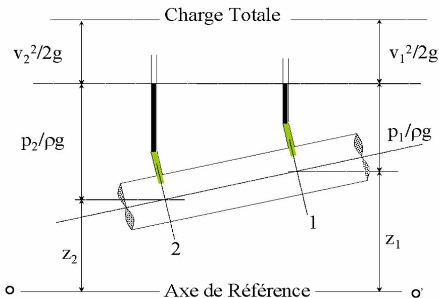
L'équation de Bernoulli exprime que , tout le long d'un filet liquide en mouvement permanent , l'énergie totale par unité de poids du liquide reste constante ( dH/dx = 0 ) . D'après le schéma , on peut donc écrire que :
