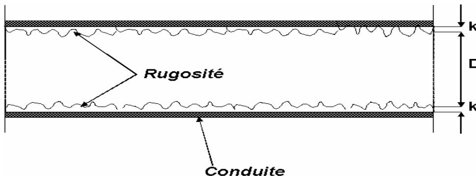
Afin de comparer la rugosité par rapport au diamètre de la conduite , on introduit le rapport :
