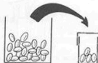
Dès la pesée, mélanger le grain avec la main. Prélever un échantillon d'environ 400 à 500 g. Le mettre dans un sachet ou une bouteille, ...
