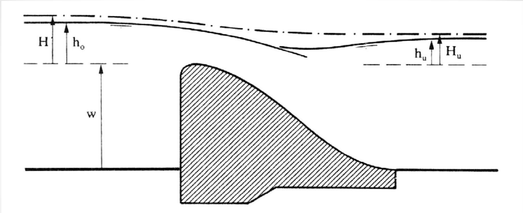
**Déversoir noyé pour lequel l'écoulement dépend des charges amont  $H$  et aval  $H_u$ .**
