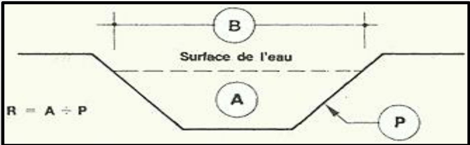
**Les caractéristiques géométriques de la section transversale mouillée des canaux sont récapitulées au **tableau 3** pour les trois types de profils les plus courants: **rectangulaire, trapézoïdal et triangulaire.****
